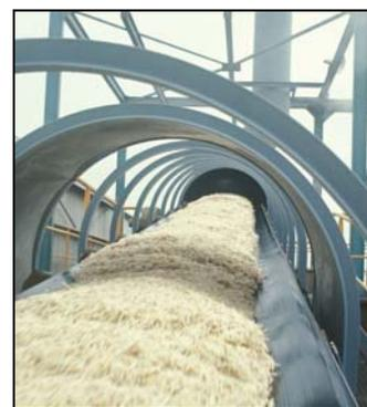
En sortie de diffusion, les pulpes contiennent environ 92% d'eau. Une grande partie de cette eau est séparée des pulpes par pressage ou déshydratation et recyclée. Les pulpes "surpressées" ou déshydratées sont utilisées dans l'alimentation animale.
