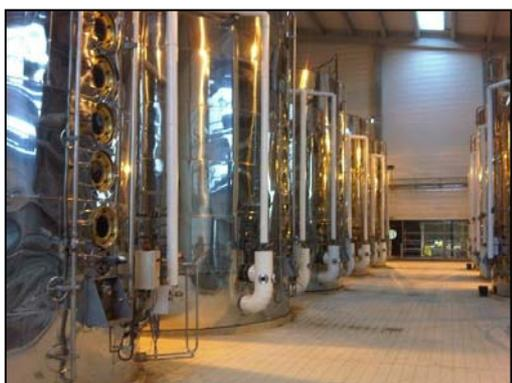
La cristallisation consiste en la séparation du saccharose (sous forme de cristaux) des impuretés (solubles) qui demeurent dans le jus concentré. La cristallisation est réalisée en 2 ou 3 étapes appelés "jets".
